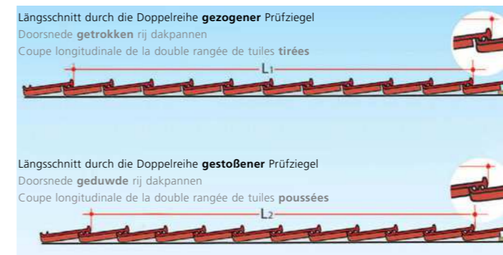
Orientierungs-Decklängen (cm) nach Anzahl der Flächenziegelreihen
