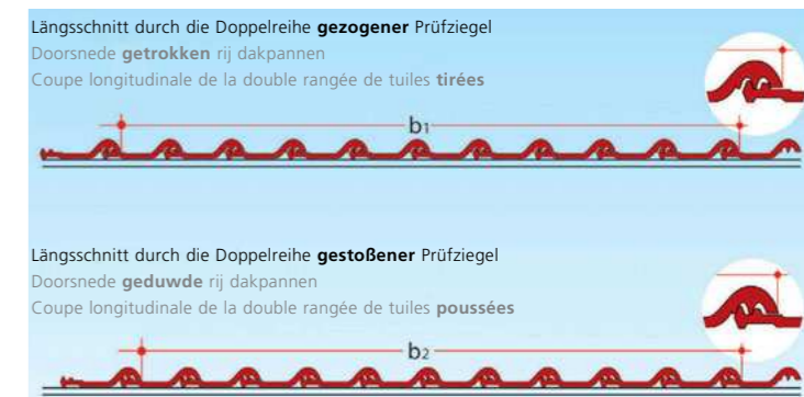
Orientierungs-Deckbreiten (cm) nach Anzahl der Ziegelreihen ohne GOZ oder Doppelkrempen
